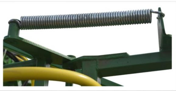
**Рисунок 7.5д Регулировка откидных секций штанги**
