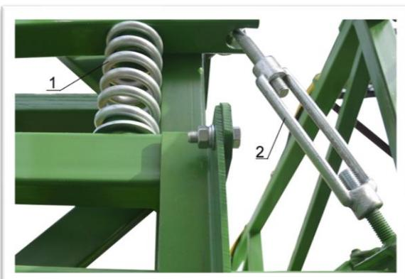
**Рисунок 7.5г Регулировка амортизационных пружин**
