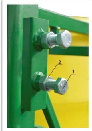
**Рисунок 7.5б Регулировка первой секции штанги**
