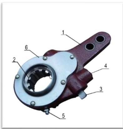
**Рисунок 4.3 Рычаг регулировочный**
